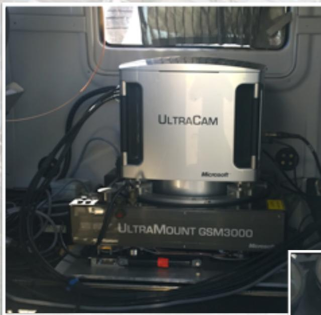
Ultracam Xp et monture GSM 3000
