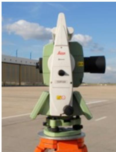
Station totale robotisée Leica 1200
