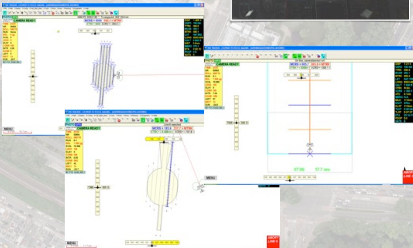
La caméra numérique Ultracam Xp est couplée à un système Applanix POS AV, comprenant la trajectographie DGPS (capteur GPS et GLONASS) et une centrale inertielle IMU (Inertial Measurement Unit). L'ensemble est géré par un système de navigation contrôlée par ordinateur Applanix POSTrack.
